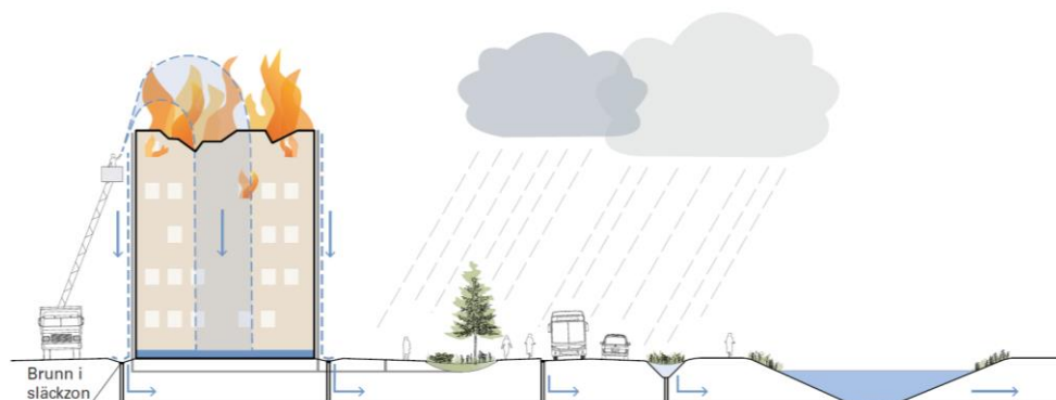
Princip för hantering av släktvatten. Källa: Gestaltungsprogram, Karavan landskapsarkitekter, 2019.
